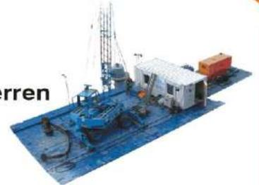
Mittels spezieller firmeneigener Technik und Erfahrung können wir alle im Unterwasserbereich anfallenden Arbeiten an Talsperren ausführen. Aufgrund der großen Wassertiefen kommen beheizbare Tauchanzüge, Nitrox-Container und die Taucherdruckbehandlungskammer zum Einsatz.
