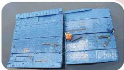
Koppelbare Pontoneinheit - aus Fluss- und Uferpontons
